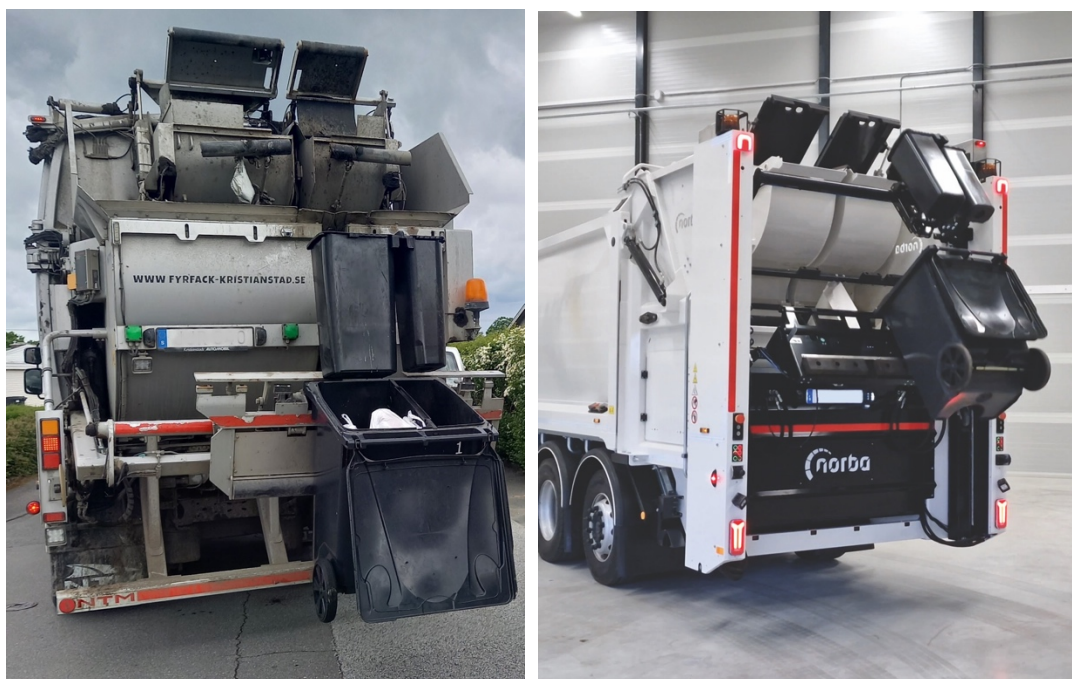
Figur 2. Två varianter av baktömmande fordon för tömning av fyrfackskärl. Till vänster en fyrfacksbil från NTM och till höger ett nyutvecklat fordon från GeesinkNorba 5 . I båda fallen töms insatsbehållarna i de två övre facken på bilen och de stora facken töms i bilens nedre fack. Foto: Miljö & Avfallsbyrån respektive GeesinkNorba.
